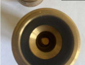
Beispielbild für Adapter mit Sinterfilter um Verschmutzungen des Systems zu verhindern
